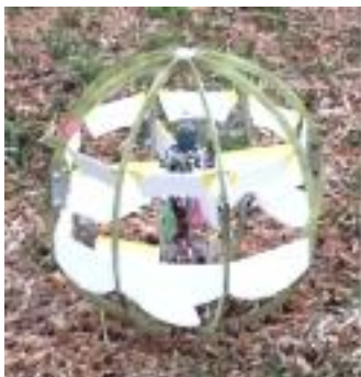
図6 FRP 試験機（3号機）の飛行テスト
